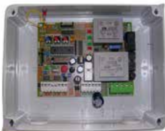
CS2E Cuadro de maniobra para un solo motor, 230 V uso intensivo y con transformador independiente para electrocerradura
