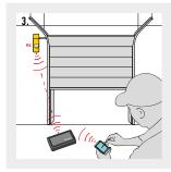
LA PRESENCIA DE UN "TRANSMISOR" EN EL INTERIOR DE LOS RECEPTORES OXIT, OX2T Y OX4T PERMITE EL ACCESO A LOS CÓDIGOS RADIO MEDIANTE LA INTERFAZ MULTIFUNCIÓN O- BOX.
