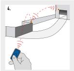
LOS RECEPTORES OXIT, OX2T Y OX4T PUEDEN UTILIZARSE COMO REPETIDORES DE SEÑAL.
